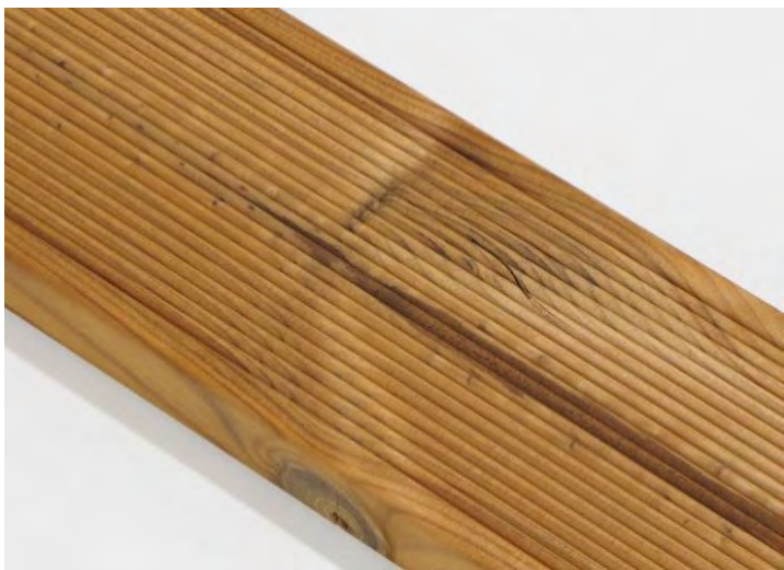
Dřeň – jádro na povrchu je povolena v celé délce.
