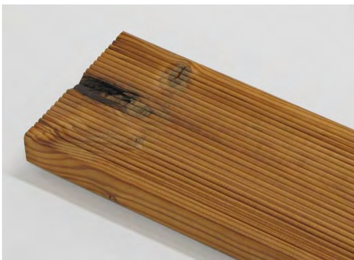
Vady na koncích prken jsou povoleny do 80 mm.
